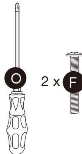
Étape 5 : Installez la partie supérieure (C) et serrez la vis 6x50 mm (F) à 80 %, ne la serrez pas complètement.
