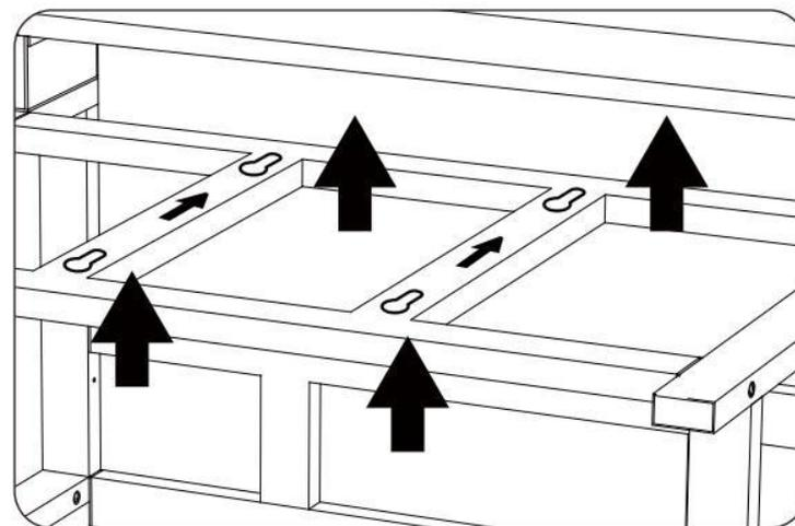
Étape 7 : Installez la partie inférieure (E) et serrez la vis 6x50 mm (F) à 80 %, pas complètement.
