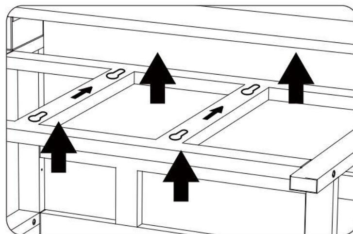
Passaggio 7: installare la parte inferiore (E) e serrare la vite da 6x50 mm (F) all'80%, non completamente.
