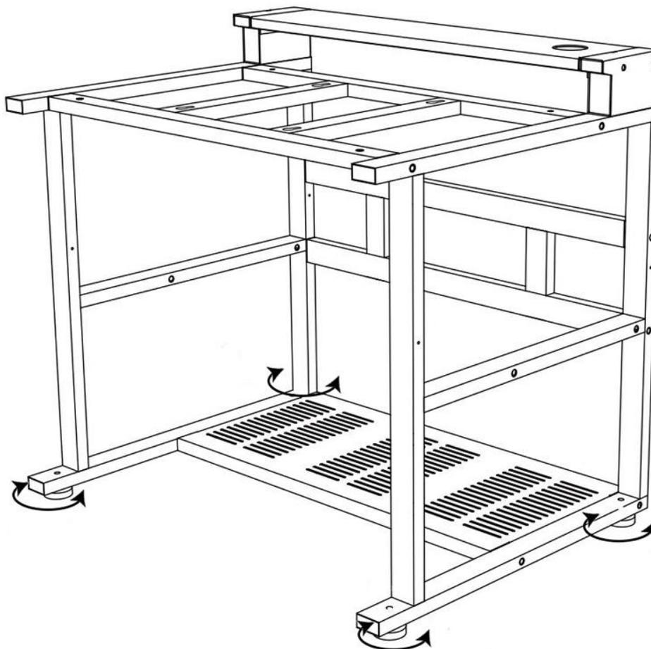
Passaggio 11: serrare le quattro viti da 6x30 mm (Q) all'80%. Non serrare completamente.
