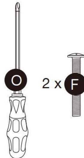
Passaggio 5: installare la parte superiore (C) e serrare la vite 6x50 mm (F) all'80%, non serrarla completamente.
