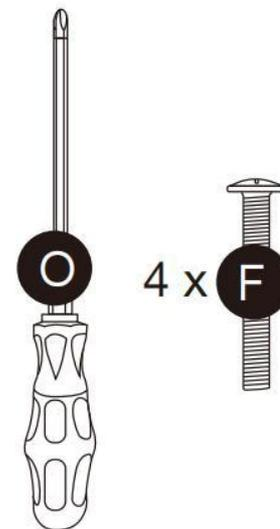
Passaggio 6: installare il supporto della console (D) e serrare la vite da 6x50 mm (F) all'80%, non completamente.
