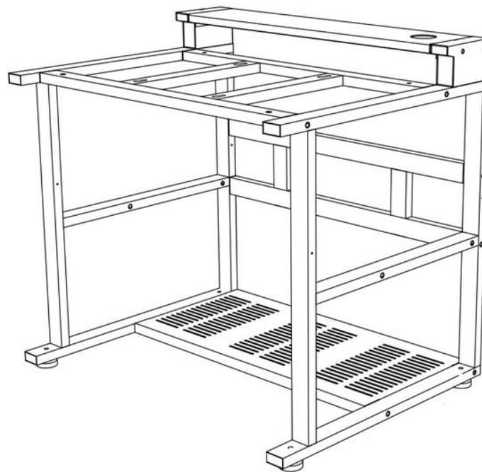
Passaggio 10: regolare l'altezza del tappetino protettivo per pavimento (G) per bilanciare la base orizzontalmente.
