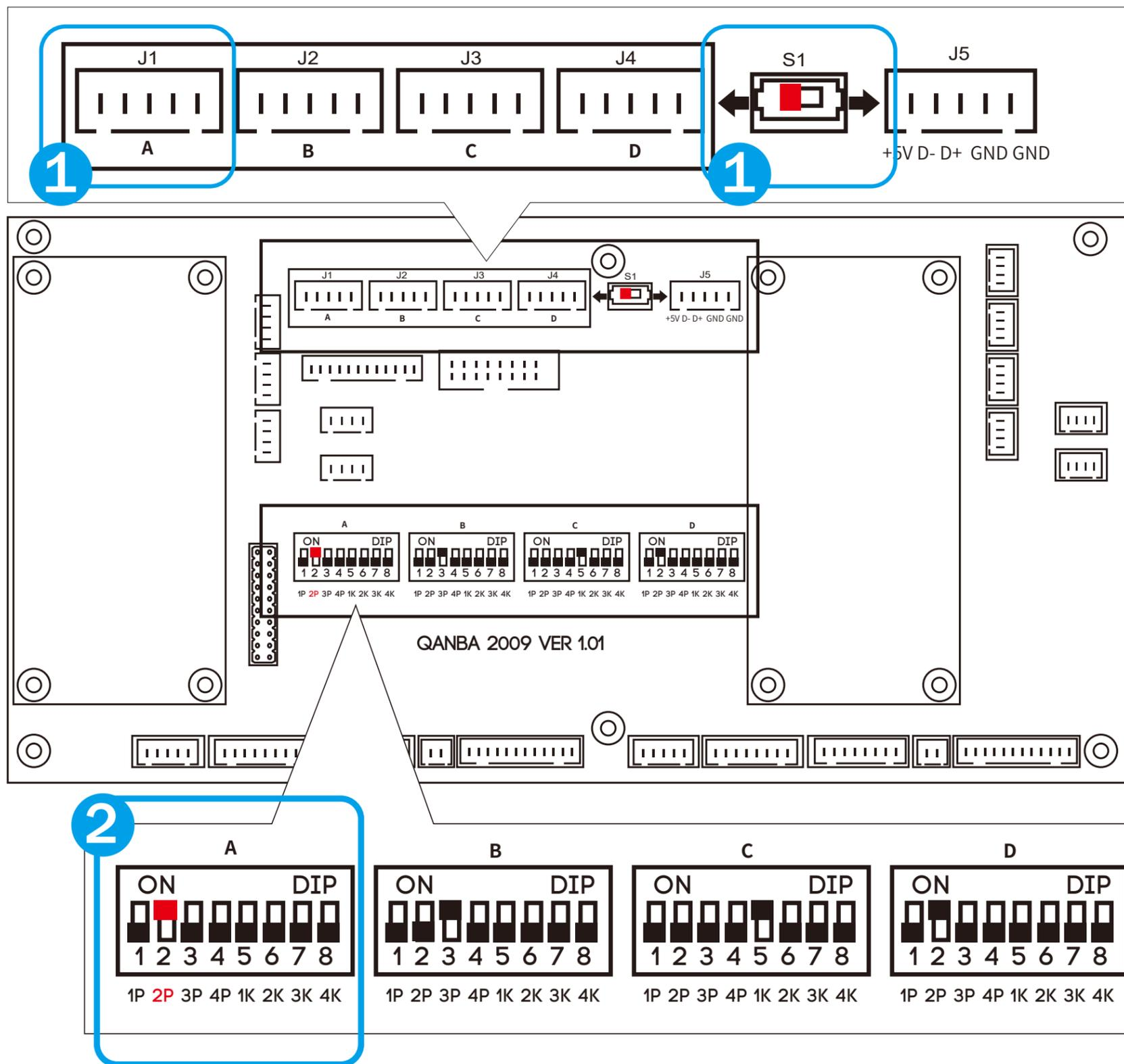
1. Le commutateur DIP S1 est en position « gauche ». Connectez le câble de données USB J1-J4 à votre appareil.
